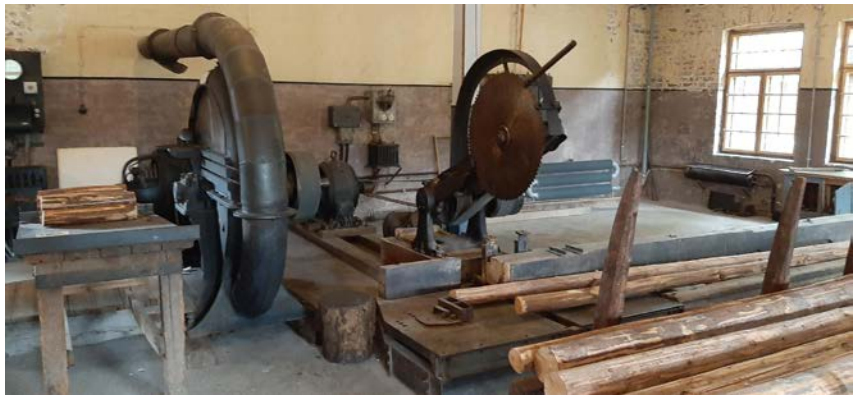
Kuorimattomat puut katkaistiin käsin sirkkelillä 50 cm pituisiksi pölkyiksi, jotka kuorittiin kuorimakoneella.
